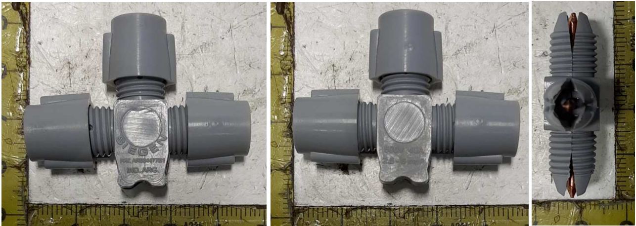
Vistas del conector para empalmes y derivaciones
